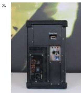
Koppla in kablar på baksidan av datorn. Nätverk (internet), HDMI (för kamera) och ström. Se till att strömknappen är på.
